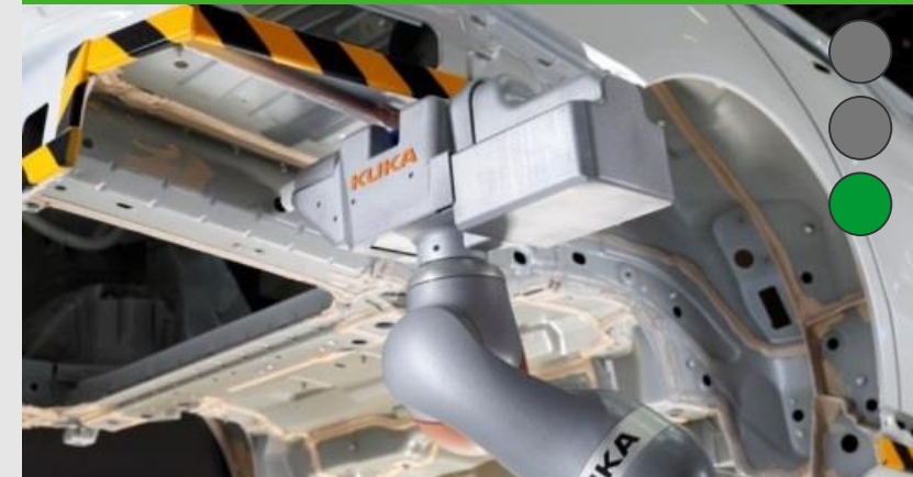
Automatisiertes Stopfensetzen mit einem MRK-fähigen Robotersystem
