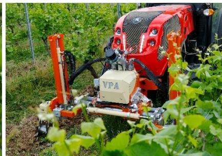
Der VineyardPilotAssistant (VPA) von Braun Maschinenbau GmbH (Landau) ist seit 2020 auf dem Markt und bearbeitet weltweit jede Saison tausende Hektar. Der eigenständige VPA Frontanbau ermöglicht auf jedem Schlepper autonomes Arbeiten mit Zentimeter-genauer Positionierung der Arbeitsgeräte zum Stock. Auf Schleppern mit Spurführungsvorrichtung (z.B. Fendt S3, S4 oder neuer) profitiert der Fahrer außerdem von der autonomen Reihenführung **RowCropPilot** assit. *Quelle: Braun Maschinenbau GmbH*
